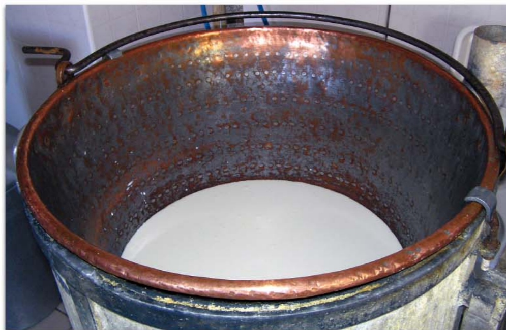
Caldaia dove il latte viene portato a 38°
